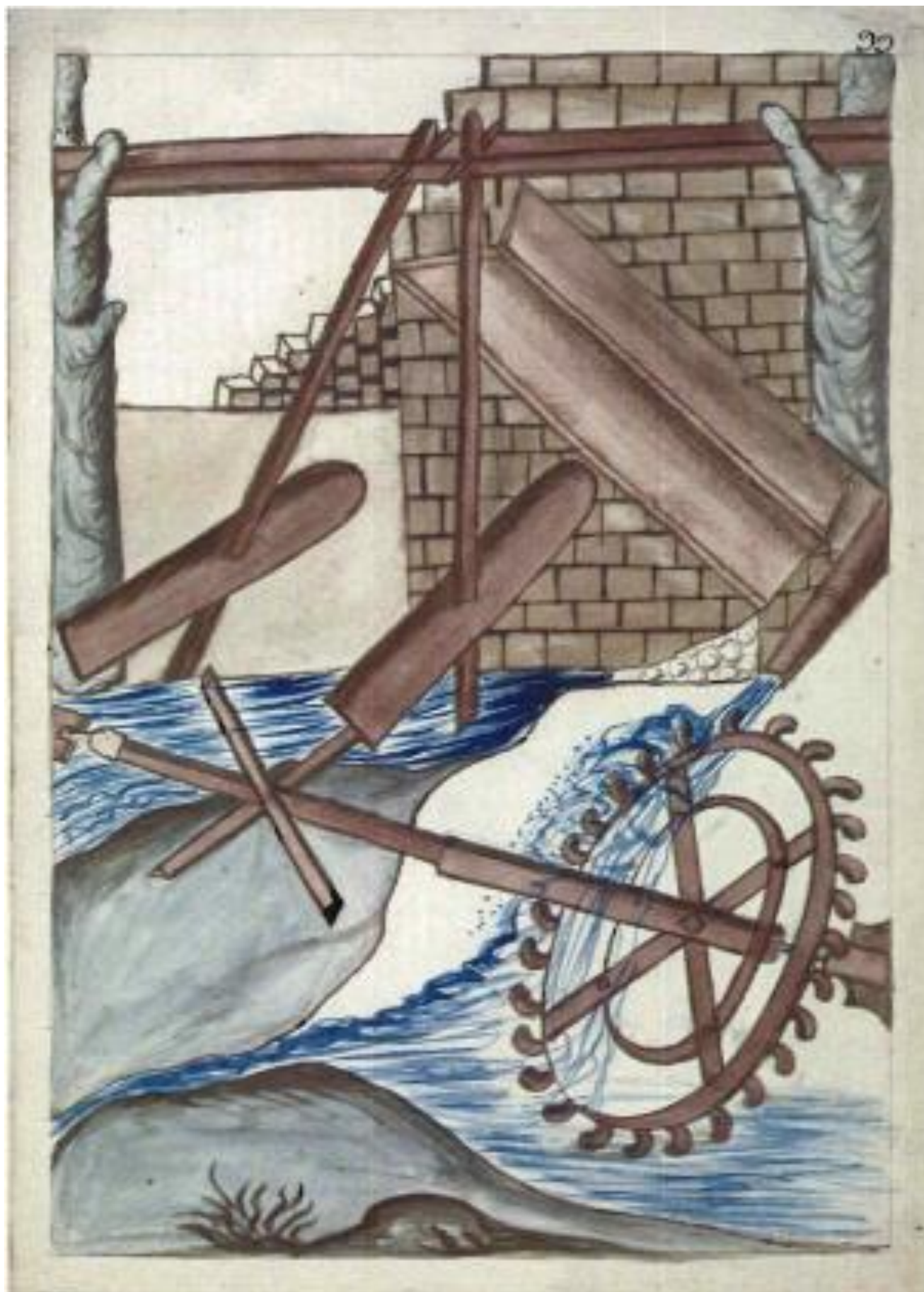
Figura 4: Esquema lateral de un batán en una de las acuarelas de Martínez de Compañón. Nota: Este ejemplar es similar a los diseñados en el siglo XI. Tomado de Macera et al. 1997 p.153.
