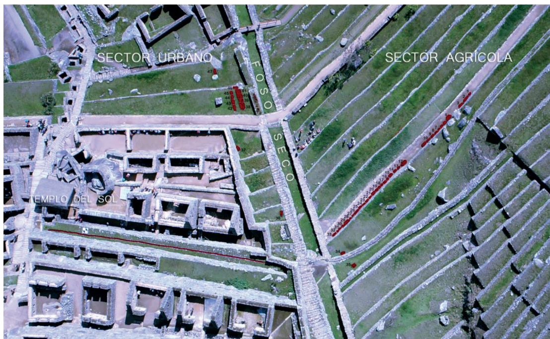
Figura 1: Futuras modificaciones - Los bloques líticos numerados de color rojo reemplazarían al segmento de canal indicado por la línea roja, mientras que el bloque marcado con color gris sería dispuesto como el puente del canal de abastecimiento de agua sobre el Foso Seco.
