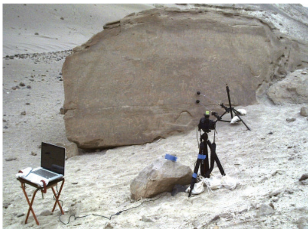
Figura 4: Equipo utilizado en la captura de imágenes digitales para Reflectance Transformation Imaging (RTI). Foto: Ana Nieves.
